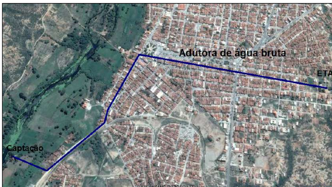
Figura 21 – Adutora de água bruta do SAA de Pombal - PB
