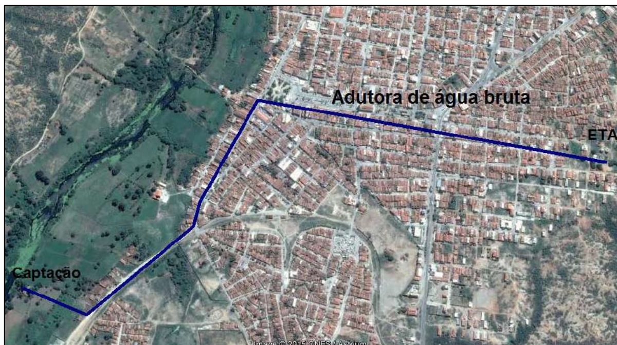
Figura 9 - Adutora de água bruta do SAA de Pombal – PB.
