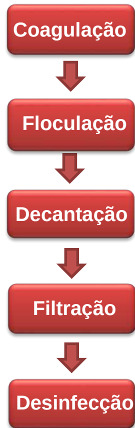
Figura 12 - Sequência de etapas realizadas no tratamento de água na ETA de Pombal – PB
